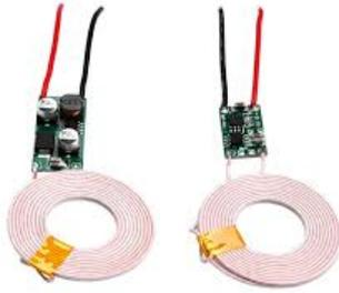
fig. 2.4 módulo inalámbrico
