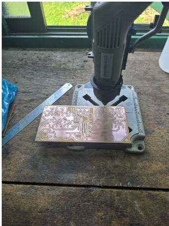
Figura 54: perforando placa
