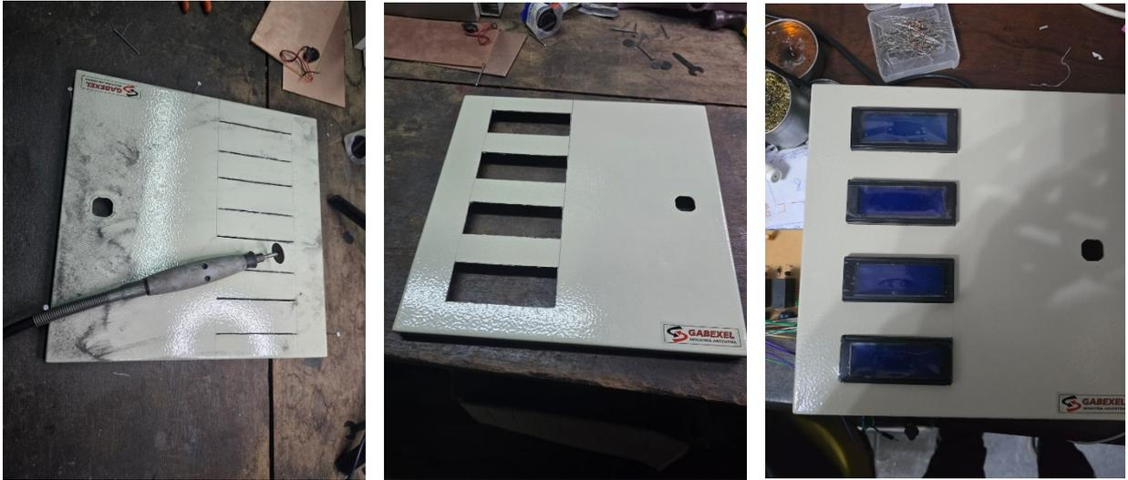
Figura 58: cortando con mini torno y colocando los display
