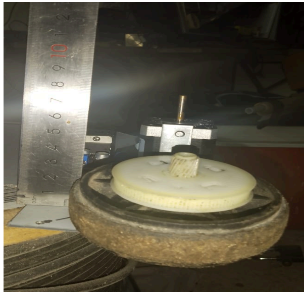
Figura 2.3 Colocación de motores y ruedas en carrocería
