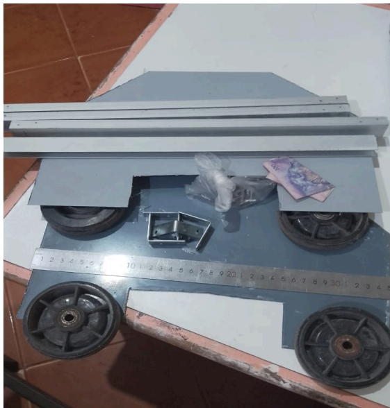
Figura 2.0 Armado de la carrocería con planchas de chapa lisa
