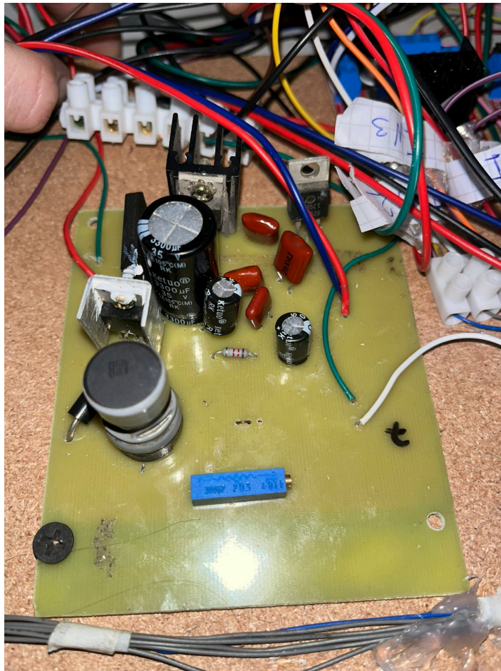
Figura X fuente conmutada variable y 5V fijos
