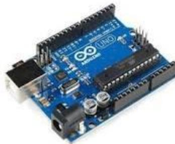
*Figura 1.3 Placa Arduino UNO*
